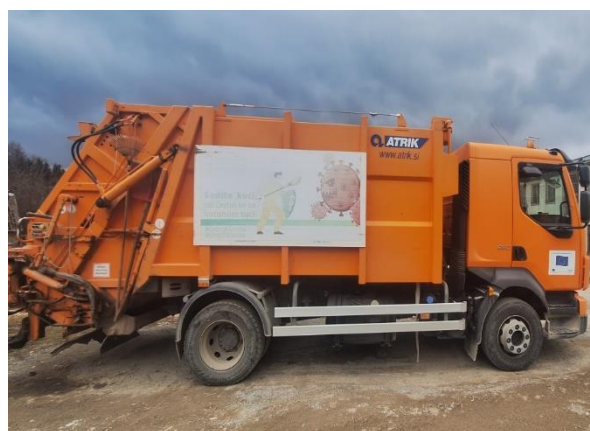
Slika 4. Komunalno vozilo, tip Volvo FL260, zapremina 12 m 3
