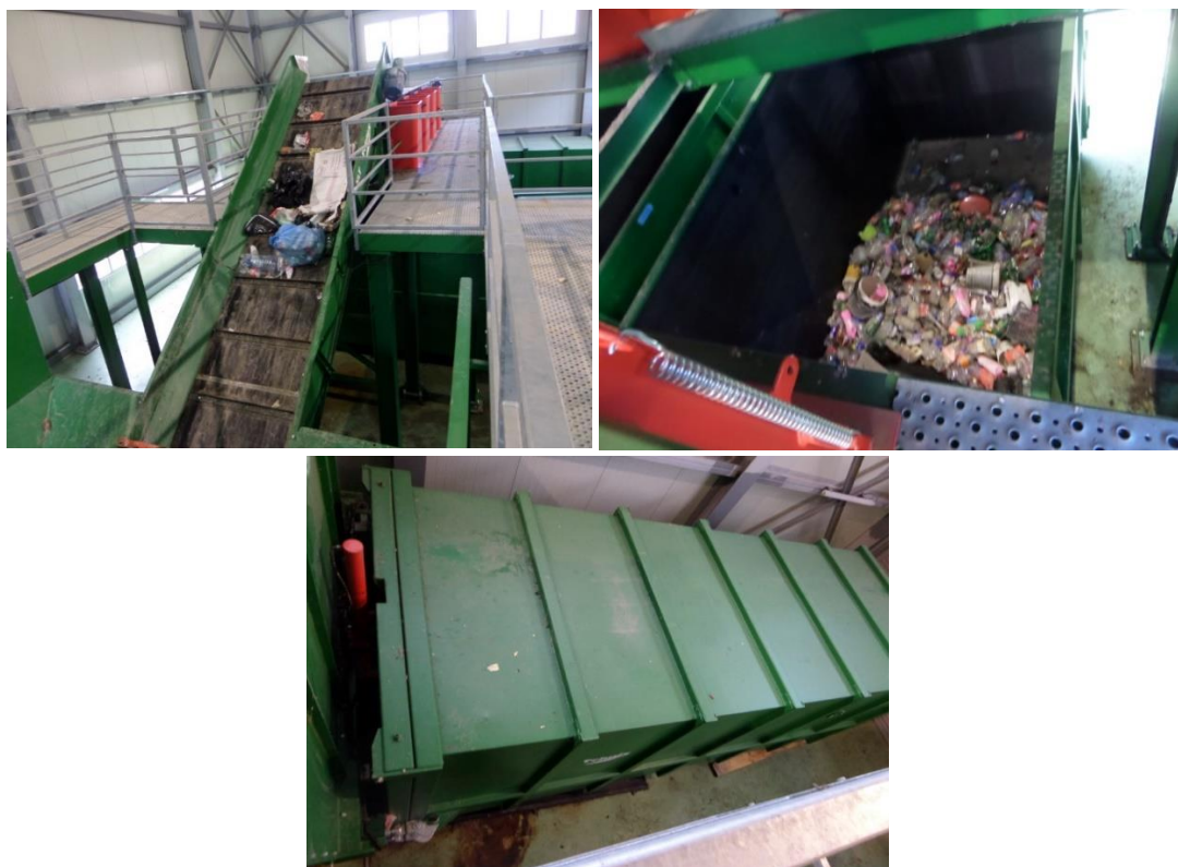
Slika 10. Tok otpada preko trakastog transportera do prese za presovanje
